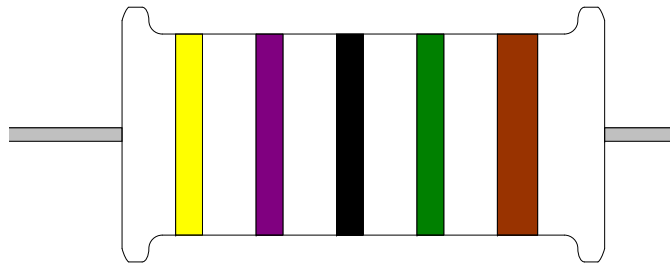
Abbildung 1.3: Ein Widerstand mit dem Wert 47 \text{ M}\Omega
